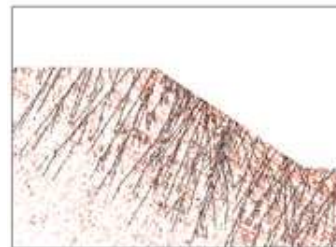
Analyse de la stabilité d'une roche : visualisation des déformations normales (rouge) et en cisaillement (en noir) et du déplacement horizontal des particules (en niveau de couleurs), à la suite de l'excavation.
